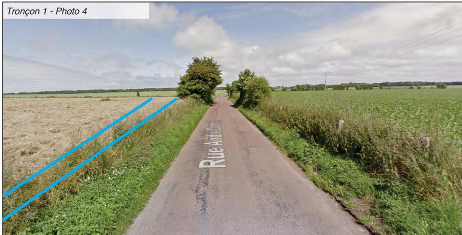
Une bande enherbée de 1,2 m de large située en bordure Ouest de la piste cyclable est mise en place.
